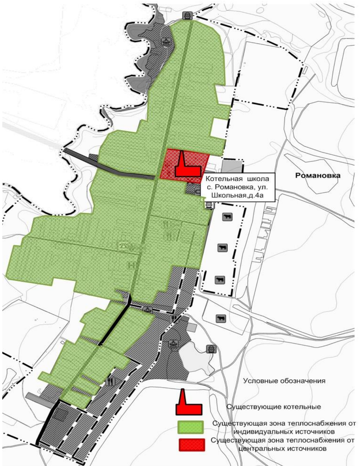
Рисунок 5 - Зоны действия централизованного и индивидуальных источников тепловой энергии на территории с. Романовка.
